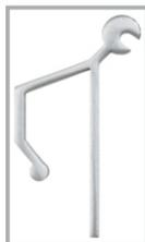
Querschnitt der **Schiebe-Profilschiene** für freistehende Modelle mit Wulst für oberen Schienen-Klemmhalter KSK (Schiene / Standrohr-Verbindung)
